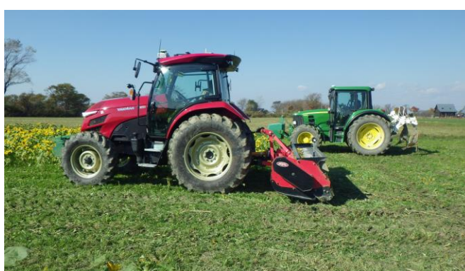
写真2 ロボットトラクタ (手前、試作機)
