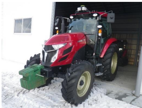
ロボットトラクタ (導入試作機) RTK-GPSを始め各種の航法センサを搭載し、 圃場内の自律走行が可能
