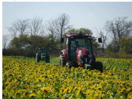
ロボットトラクタ先行-有人トラクタ追従による 協調作業の例 (ひまわりチョッパー-サブソイラ)
