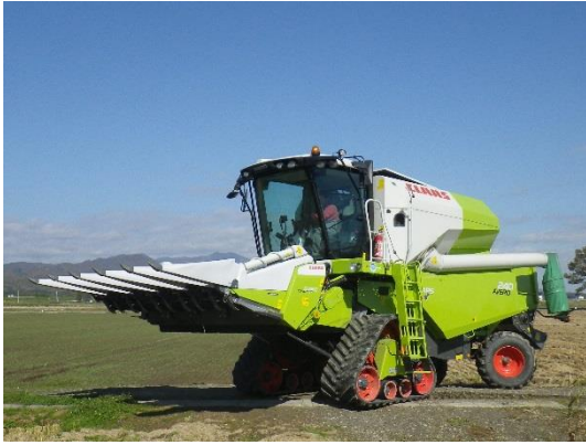
収穫機：普通コンバイン「AVERO240」 (コーンヘッド装着) 畑作地帯の主力サイズよりも一回り小さな中型で、 水田作地帯に比較的導入しやすい
