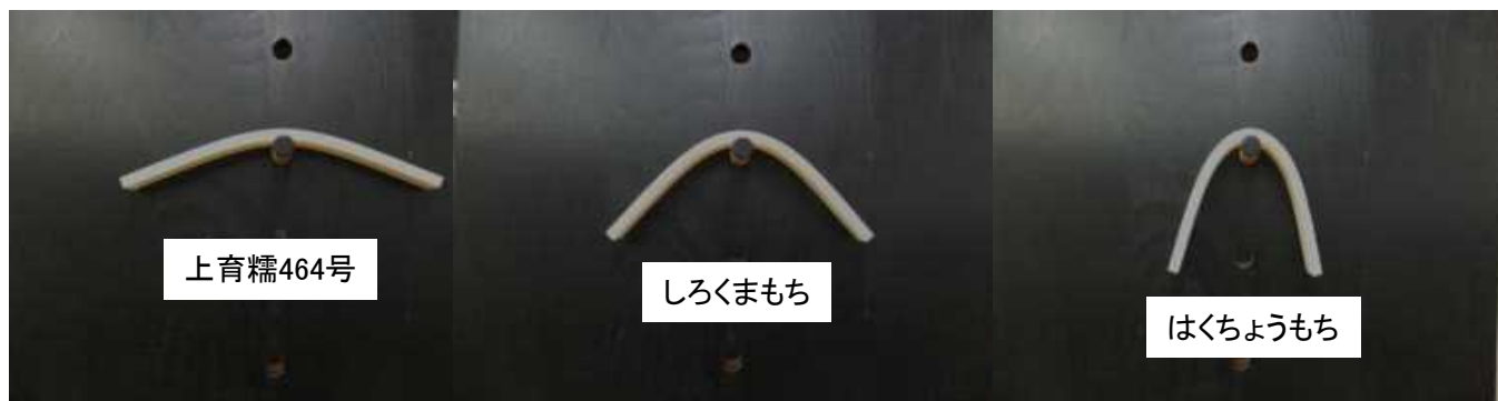
写真 上川農試産米による曲がり法の結果 (平成24年) 注) 長さ50cm、厚さ1.5cm、幅5cmに調製したもち生地5℃約24時間後
