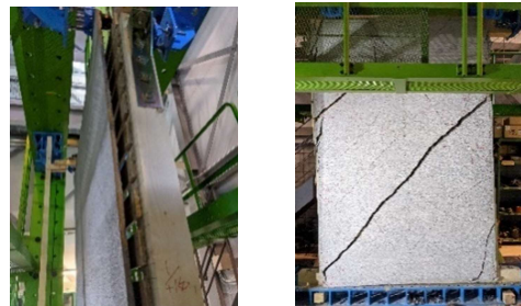
(a) No100のモルタル剥離 (b) No101の亀裂
