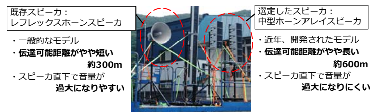
図3 屋外スピーカの比較試験(神恵内村)
