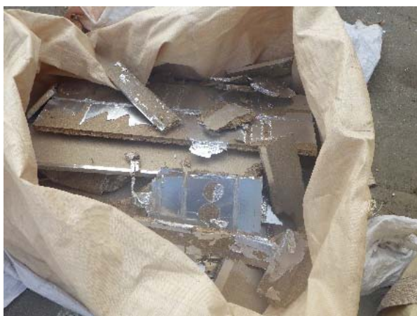
写真 2-30 金属のシートが付いた木質ボード (C)
