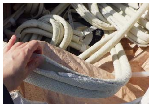
写真 2-27 配管から剥がしたプラスチック製断熱被覆 (C)
