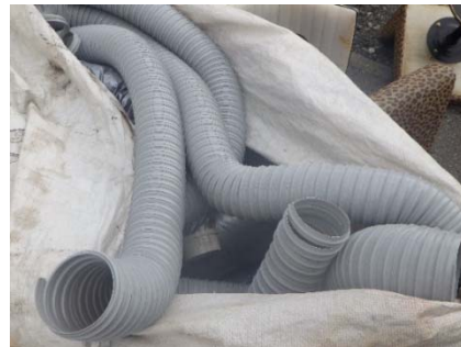
換気用のプラスチック製フレキシブルダクト (C)
