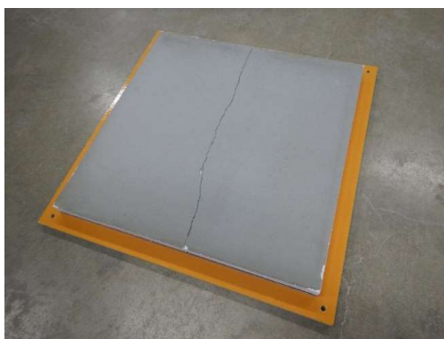
図 2-4 模擬ひび割れモデル試験体
