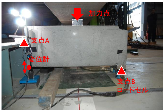
写真 4 試験体加力状況
