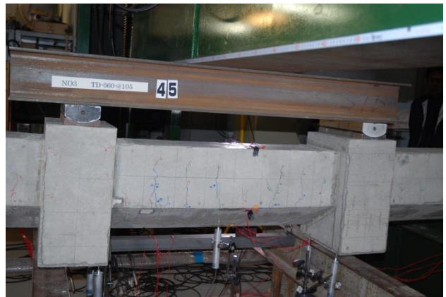
图 B-6 自由端支持四点曲げ試験(TD-060-@105)
