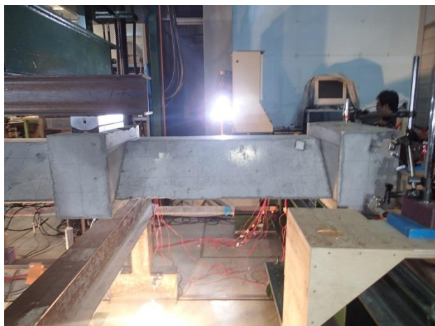
图 B-11 自由端支持四点曲げ試験(TB-045-@105)
