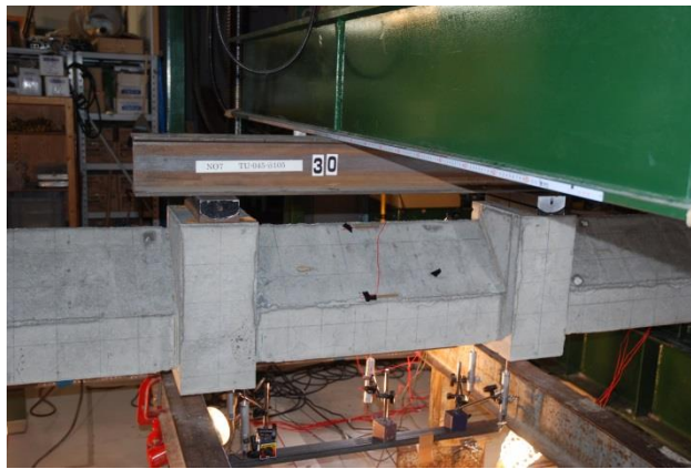
图 B-10 自由端支持四点曲げ試験(TU-045-@105)
