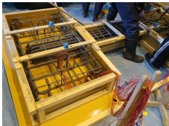
図 4-3 コンクリート打設時試験体状況
