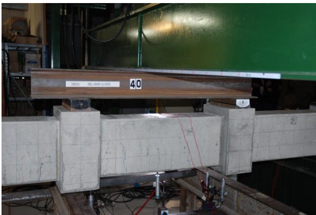
図 B-4 自由端支持四点曲げ試験(SL-000-@105)
