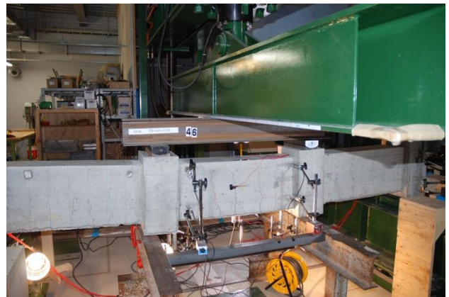
图 B-9 自由端支持四点曲げ試験(TD-045-@105)
