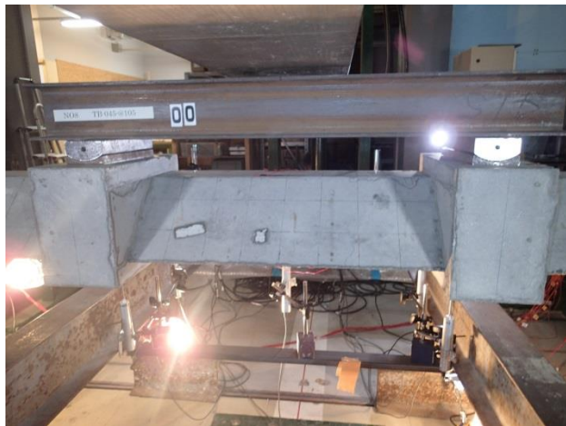
图 B-10 自由端支持四点曲げ試験(TU-045-@105)
