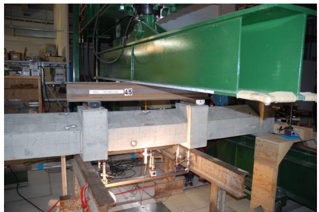
图 B-7 自由端支持四点曲げ試験(TU-060-@105)
