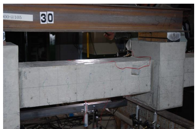
図 B-5 自由端支持四点曲げ試験(SS-000-@105)
