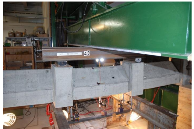
图 B-10 自由端支持四点曲げ試験(TU-045-@105)
