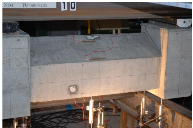
图 B-6 自由端支持四点曲げ試験(TD-060-@105)
