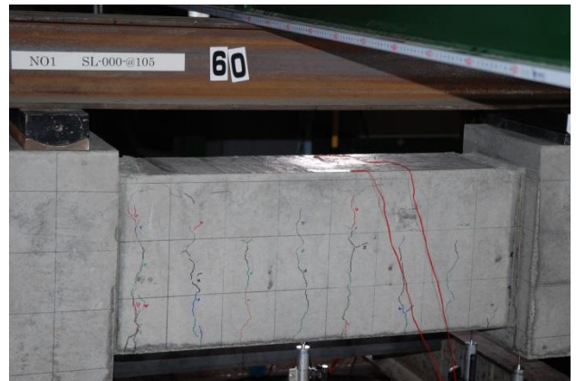
図 B-4 自由端支持四点曲げ試験(SL-000-@105)
