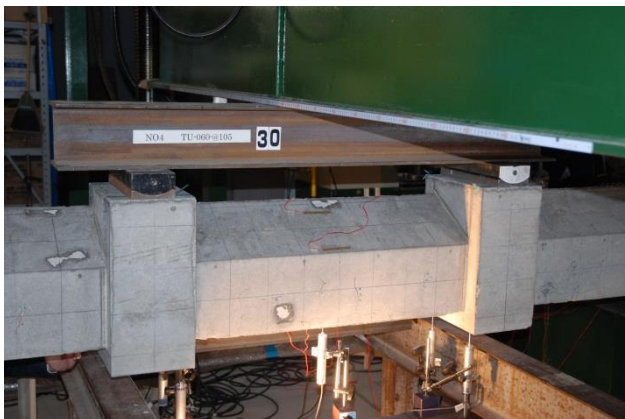
图 B-7 自由端支持四点曲げ試験(TU-060-@105)
