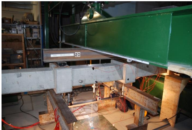
图 B-8 自由端支持四点曲げ試験(TB-060-@105)
