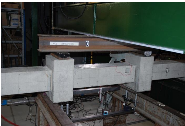
図 B-4 自由端支持四点曲げ試験(SL-000-@105)
