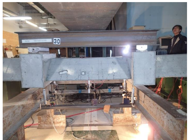
图 B-11 自由端支持四点曲げ試験(TB-045-@105)
