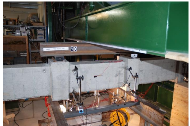
图 B-8 自由端支持四点曲げ試験(TB-060-@105)
