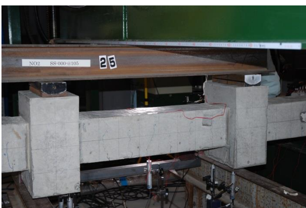
図 B-5 自由端支持四点曲げ試験(SS-000-@105)
