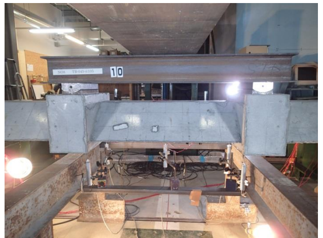
图 B-10 自由端支持四点曲げ試験(TU-045-@105)
