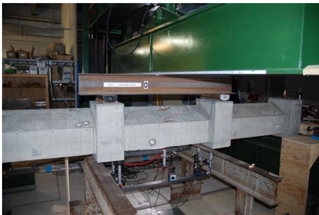
图 B-6 自由端支持四点曲げ試験(TD-060-@105)
