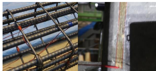
図4-6 試験体部における変位計等計測位置図
