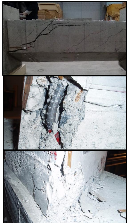
図 1-2 曲げシリーズ試験体の脆性的な破壊形式（上：せん断亀裂、中：主筋の座屈、下：圧壊）
