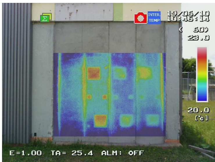
写真 3-9 モルタル外壁試験体の撮影熱画像
