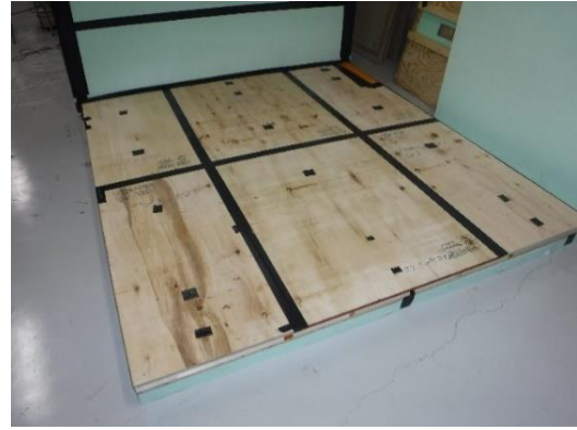
写真 7 有効開口面積測定の様子
