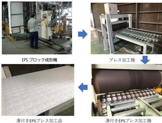
図 15 排水溝のプレス加工の工程
