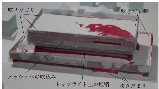
写真 2-6 西面の堆積状況
