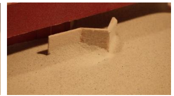
写真 2-18 西面の出入口前の防雪壁と吹きだまり状況
