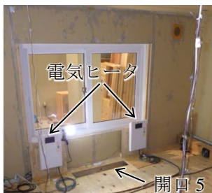
図 3-7-2 開口とファンの設置位置 (図中の温度は電気ヒータの設定値)
