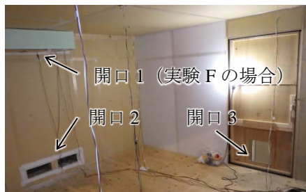
写真 3-7-1 開口とファンの設置状況
