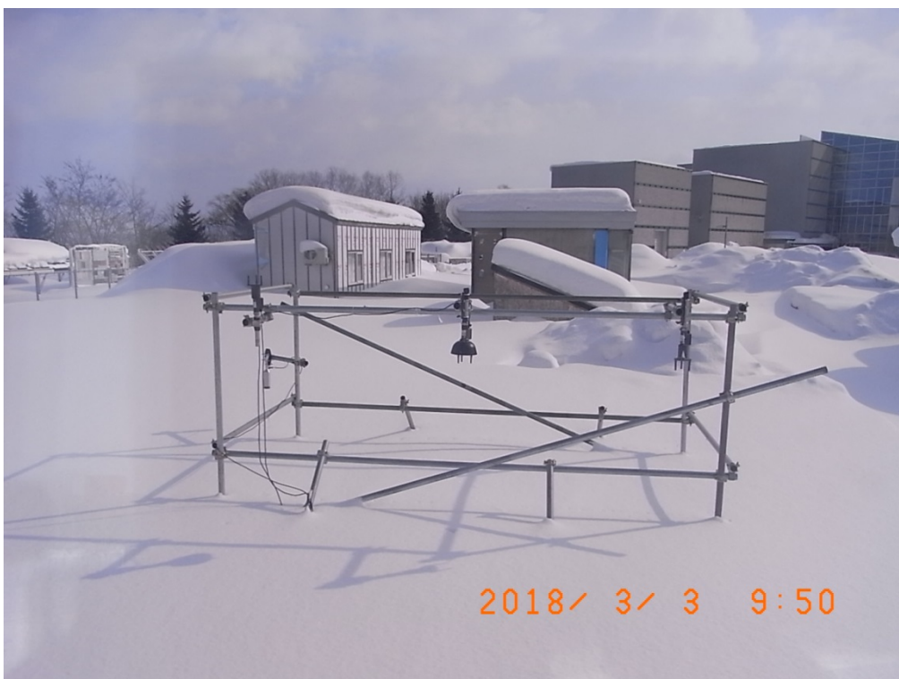
写真 20 2018/3/3 における風向風速計の着雪状況
