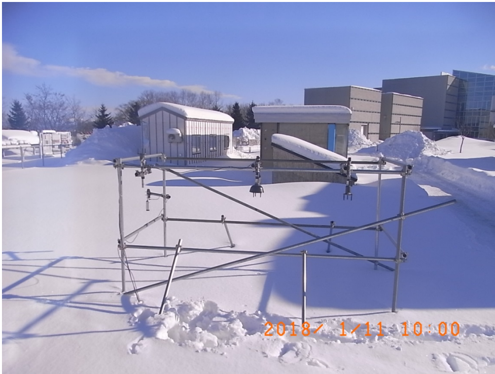
写真7 2018/1/11における風向風速計の着雪状況
