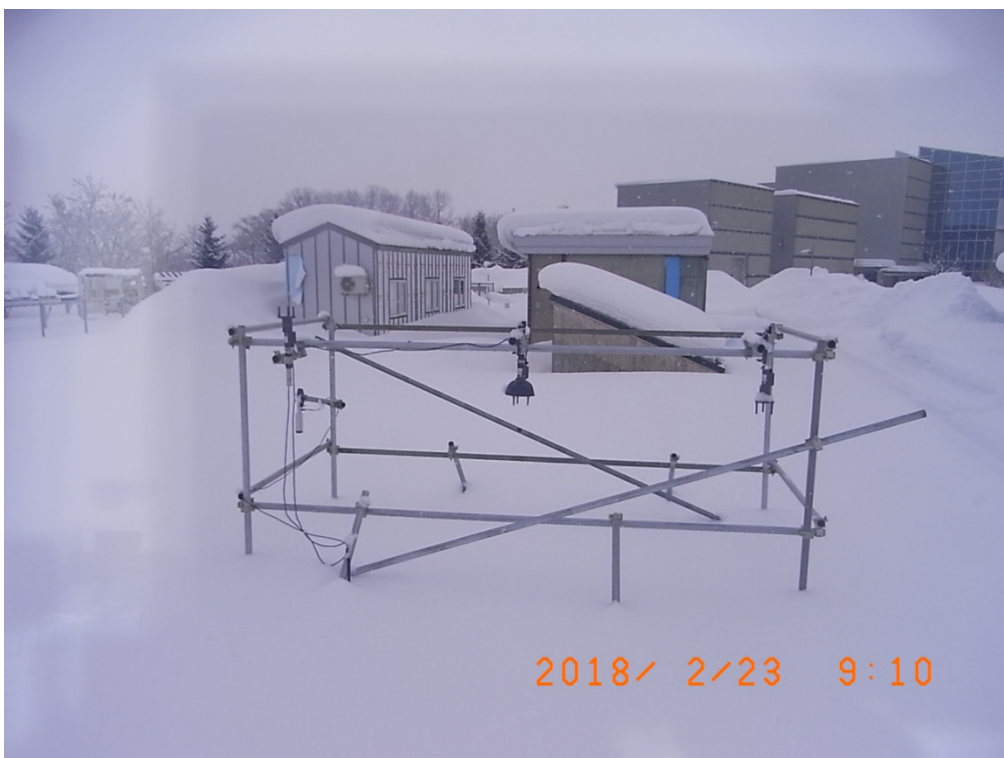
写真 18 2018/2/23 における風向風速計の着雪状況
