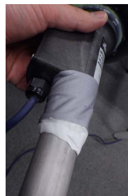
(b) 風向風速計の結合部の処理
