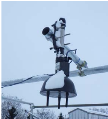
写真 1 積雪による欠測を軽減する新たな設置方法 図 1 屋外実験における取得データの比較結果 (2017/3)
