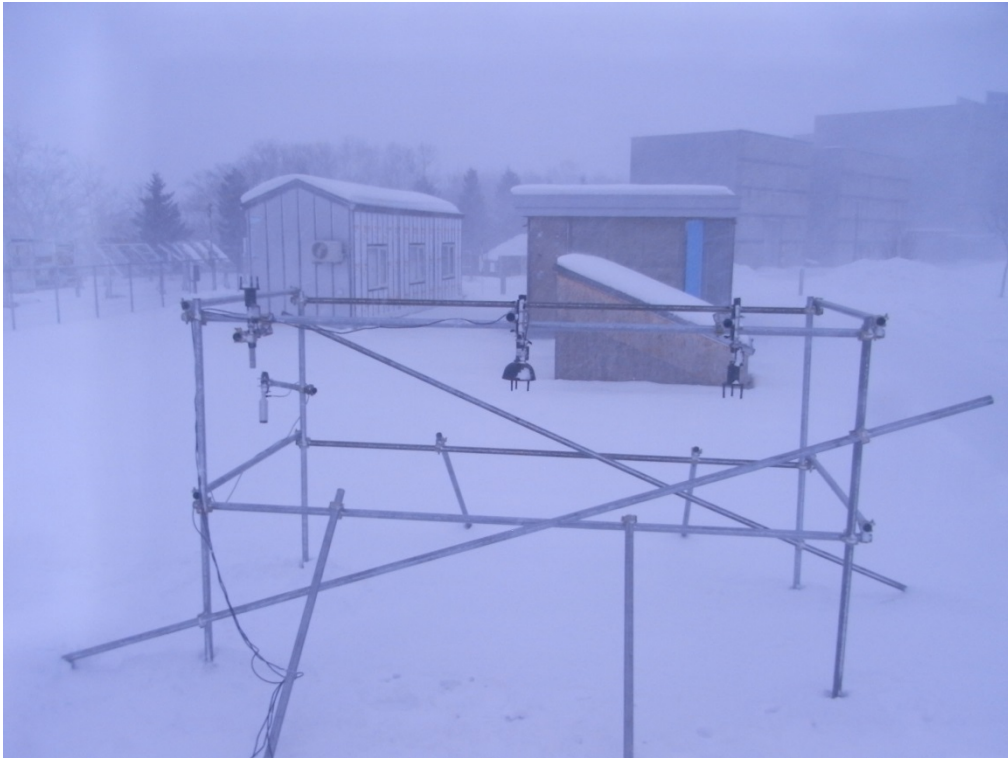
写真1 2017/12/25における風向風速計の着雪状況
