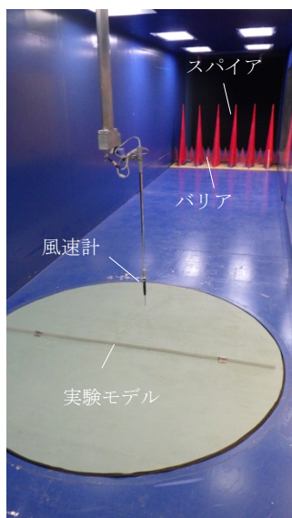
写真 3-2 測定部の状況
