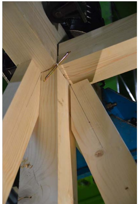
写真 7-6 筋かい頭部の釘の引き抜き [右が直交面] (試験体 No. 13)
