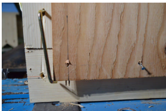
N釘の引き抜き・構造用合板の反り
