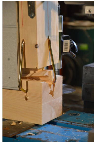
かすがいの引き抜け かすがいによる土台割裂
