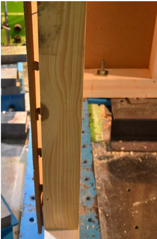
写真 7-5 釘の引き抜き、ボードの浮き (試験体 No. 9)
