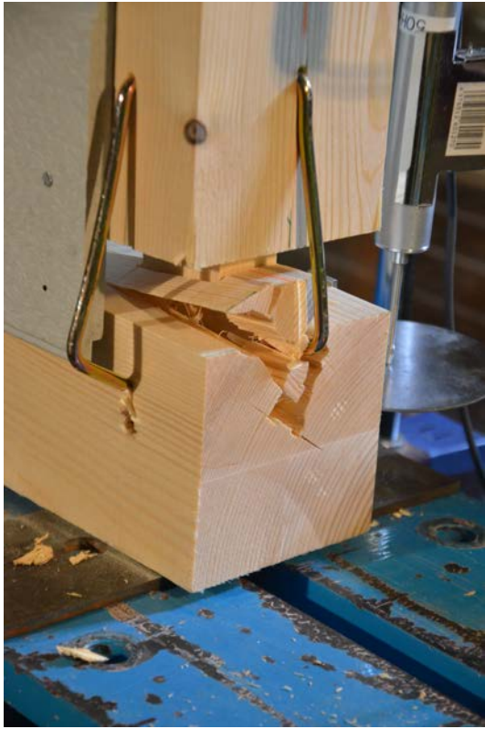
写真 7-3 かすがいの引き抜け、 土台の割裂 (試験体 No. 1)
