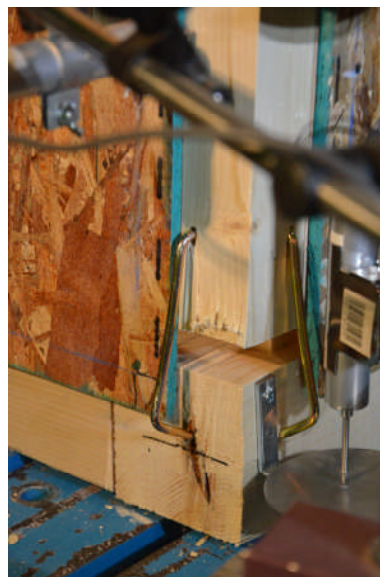
かすがいの引き抜け
