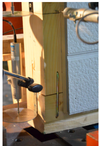
直交壁端柱脚の引き抜き
