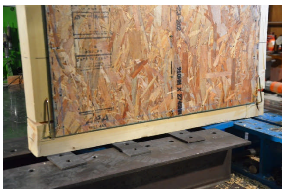
隅柱・直交壁端部柱の引き抜け
