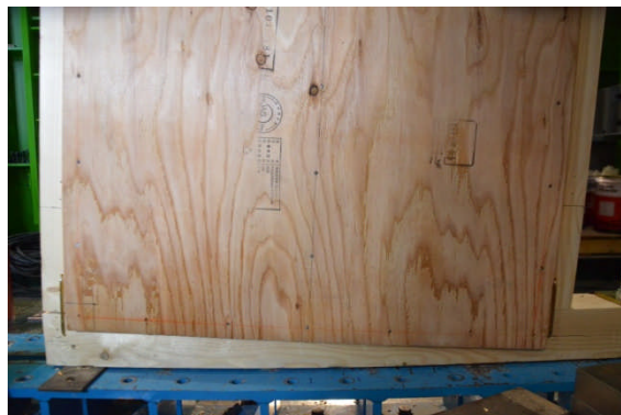
N釘の引き抜き・めり込みによる 構造用合板の回転
