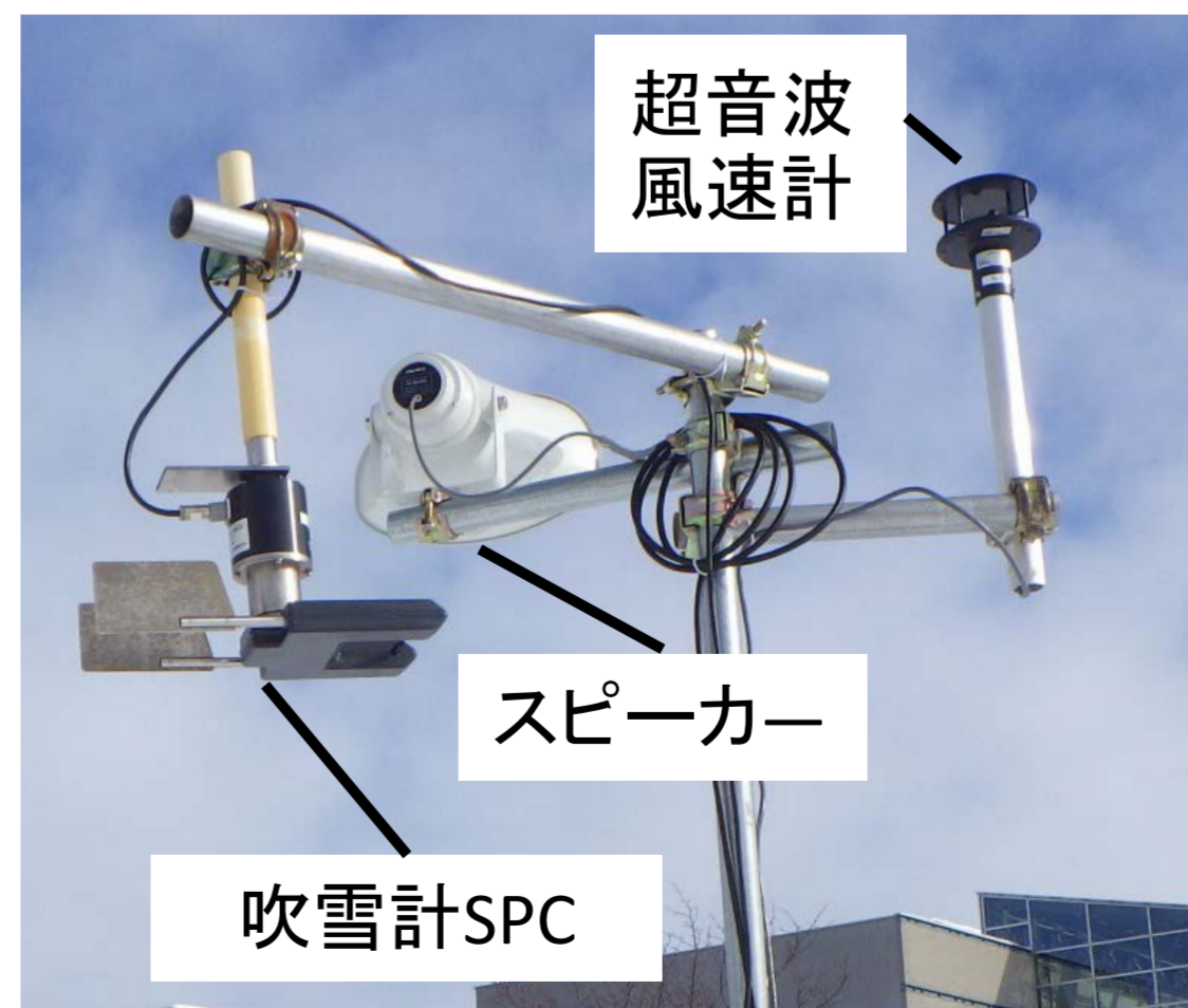
図4 機材設置状況
