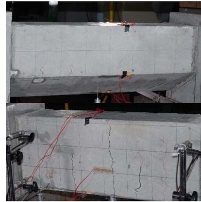
図6-2 長辺部と短辺部のひび割れ発生状況
