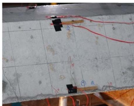
図 4-6 コンクリート歪みゲージ配置計画及び貼付状況
