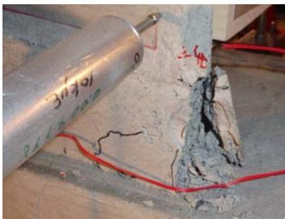
図 5 先端部の圧壊状況
