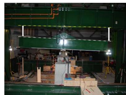
図 6-1 自由端支持四点曲げ試験 試験機の変形
