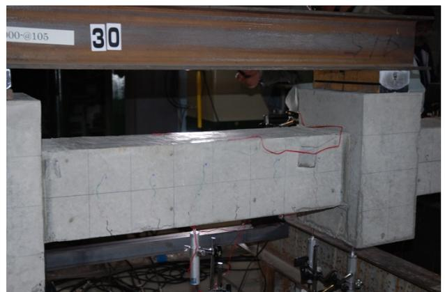
图 B-5 自由端支持四点曲げ試験(SS-000-@105)
