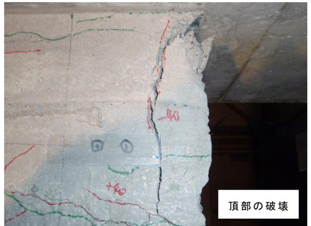
図 C-7 端部固定水平加力試験(TN-060-@105)
