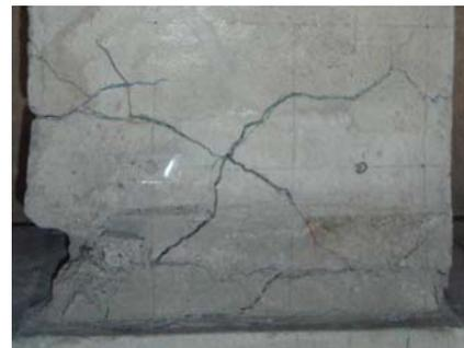
図 6 長方形置換断面とのひび割れ性状の違い
