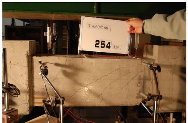
図 A-5 予備試験加力試験写真(T-060-@60)
