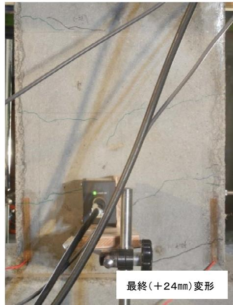
図 C-4 端部固定水平加力試験(S0-000-@105)
