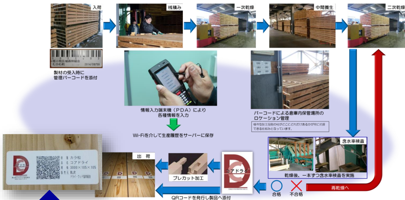
図2 「コアドライ®(製材) 品質管理システム」の実生産フロー
