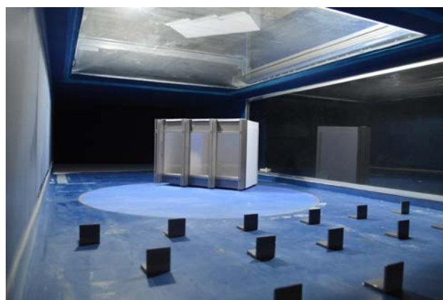
写真5-3 実験モデルの設置状況 (ディテール模型)
