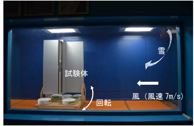
図 5-4 試験体の設置状況
