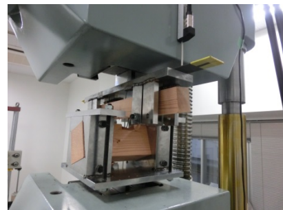
写真 4-1 軒桁-垂木接合部の実大試験
