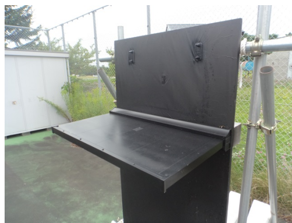
写真 3-1 試験体 No. 1 (壁：低反射、庇：低反射)
