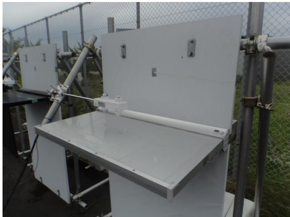
写真 3-3 試験体 No. 3 (壁：高反射、底：高反射)
