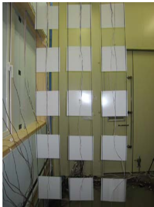
(b)樹脂板裏面熱電対設置状況
