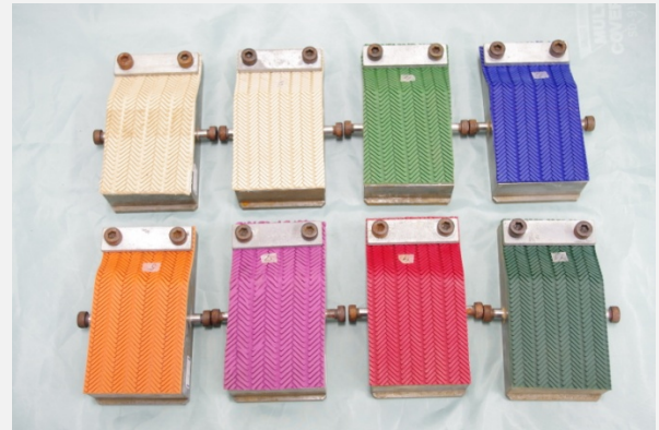
写真1 靴底の滑り試験片
