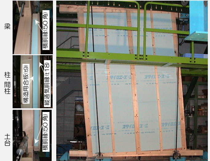
※接合具：構造用面材-CN50@150、横・縦通気胴縁-「バ」初ド P6-120」または「X-ホ」初ド入 6.0×130」 使用した断熱材：XPS3種、EXS特号、PF1種2号、PUF2種2号
