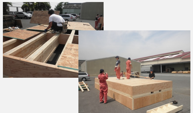
写真2 I-Joist 床組での官能実験
