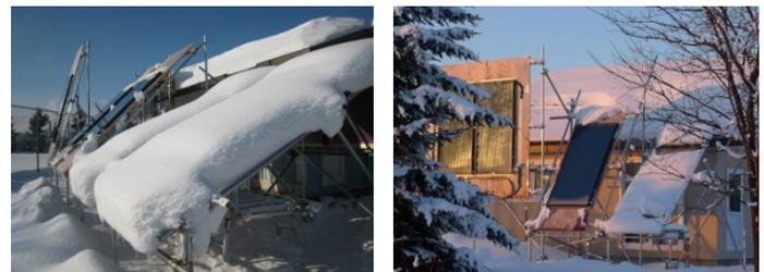
写真1 集熱器の落雪試験の状況
