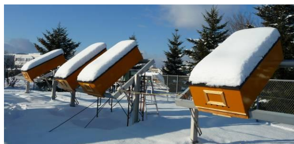
写真2 模擬屋根による滑雪性観測
