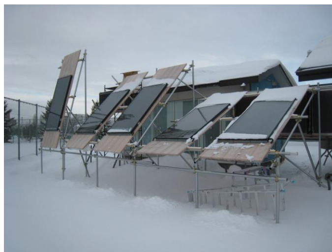
写真1 集熱器の落雪試験の状況
