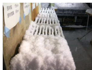
写真2 ルーバー庇の積雪実験
