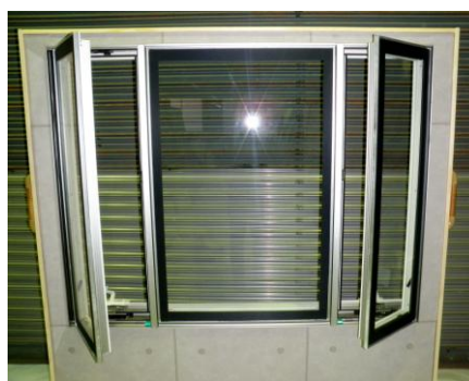
図3 1次試作品（アルミ樹脂複合窓・外気側）
