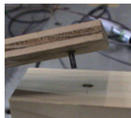
◀加振により破断した釘(N50)
