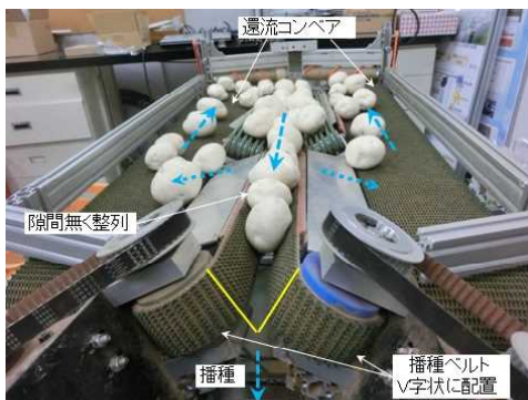
図1 高速搬送・播種機構（室内試作機）
