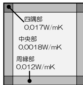
図4 真空断熱材の各部の熱伝導率の例
