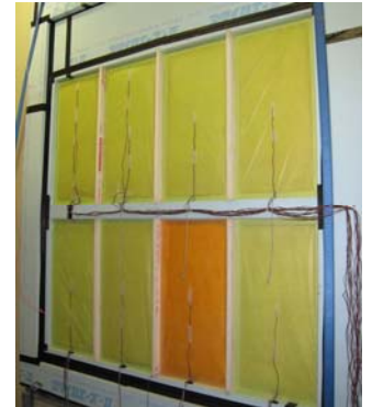
図2 防露実験の状況
