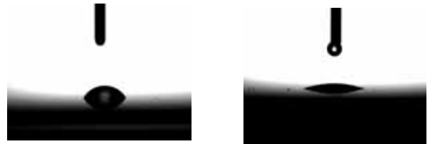
図1 水接触角(左60度、右18度)
