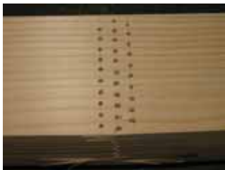
(a)穿孔 3×31箇所 (残存強度 77%)
