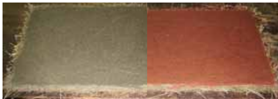
写真1 着色した細木毛セメント板(左:顔料3%、右:染料3%)
