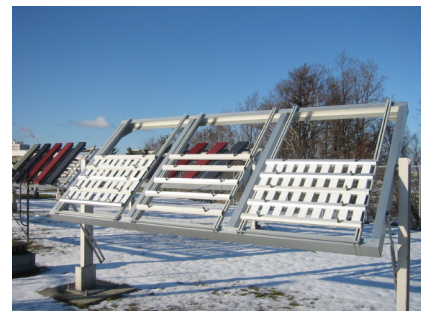
屋外暴露試験状況
