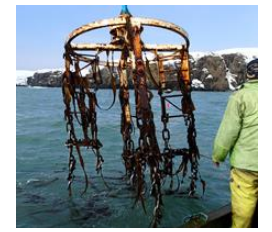
SKフープ方式による雑海藻 駆除の様子 チェーンのついた円盤を船 上から海底に入れ、油圧で 回転させ雑海藻を削り取る。
