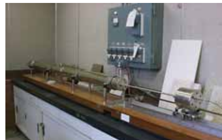
写真1 垂直入射吸音率測定装置 (北海道立工業試験場)
