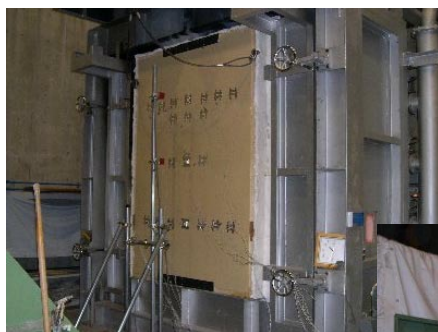
载荷加熱終了時の試験体。
