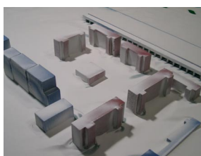
風洞実験による模型雪の堆積状況
