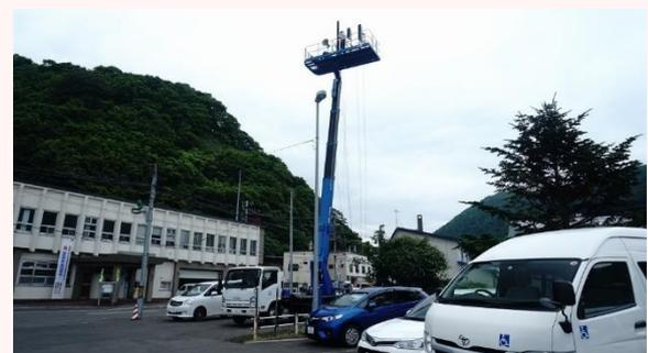
高所作業車を用いた防災スピーカーの実大試験
