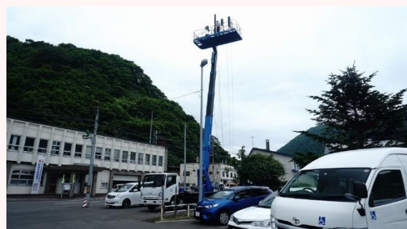
高所作業車を用いた防災スピーカの実大試験
