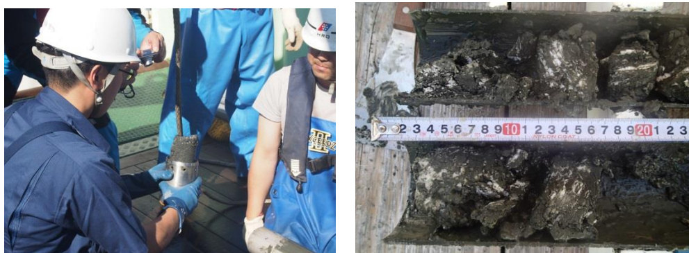
図 1. 採取状況 (左) と泥にはさまれた白い氷状のメタンハイドレート(右)
