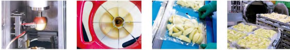
皮むき → カット → 真空パック → 加圧加熱殺菌
