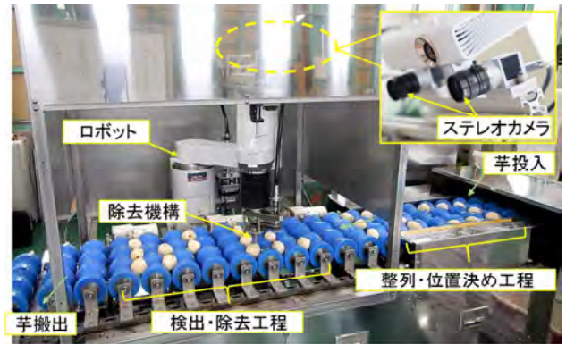
図7 自動芽取りシステム (第一試作機)
