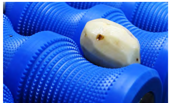
図2 整列・位置決め機構（第二試作機）
