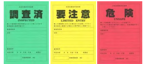
判定済の建物に掲示されるステッカー
