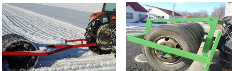
写真 III-4 けん引式（左）および直装式（右）のタイヤローラ
