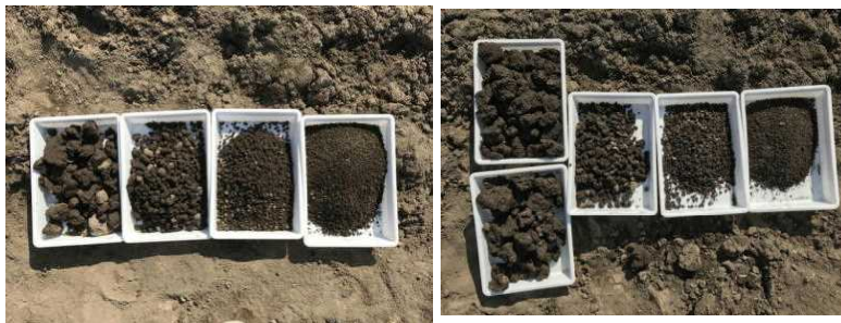
写真IX-3 土壤凍結の有無による碎土性改善効果
