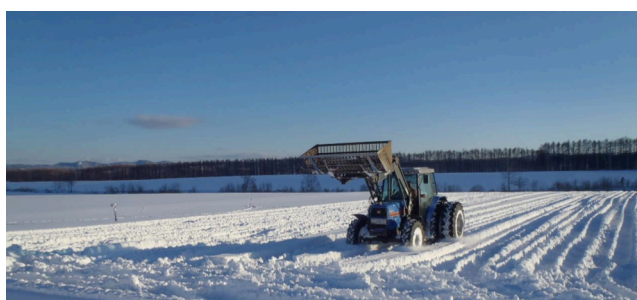
写真 III-5 トラクタのタイヤのみで行った雪踏み実施状況
