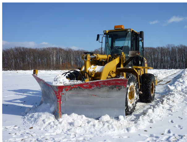
写真1-1 V羽根による雪割り
