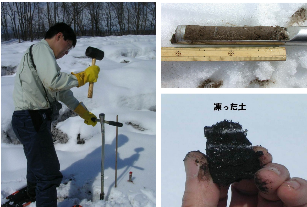
写真 III-6 左 ルートオーガーによる凍結土壌の採土の様子
