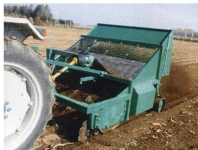
土中のイモを表層に集めて、凍結しやすくする
