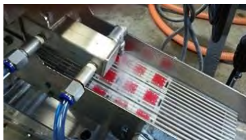
人造イクラを用いた着色剤洗浄試験
