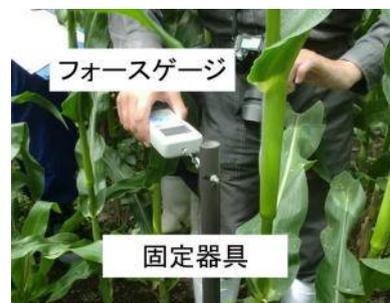
写真3 引き倒し力の測定
